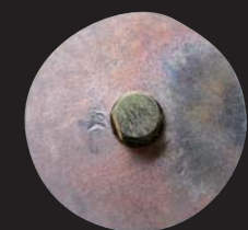
新素材 高熱伝導素材で熱を素早く逃がし、風車の機関部を雷から守る。
