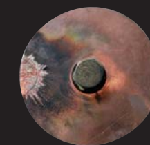
従来素材 雷の熱で溶けてしまう。
